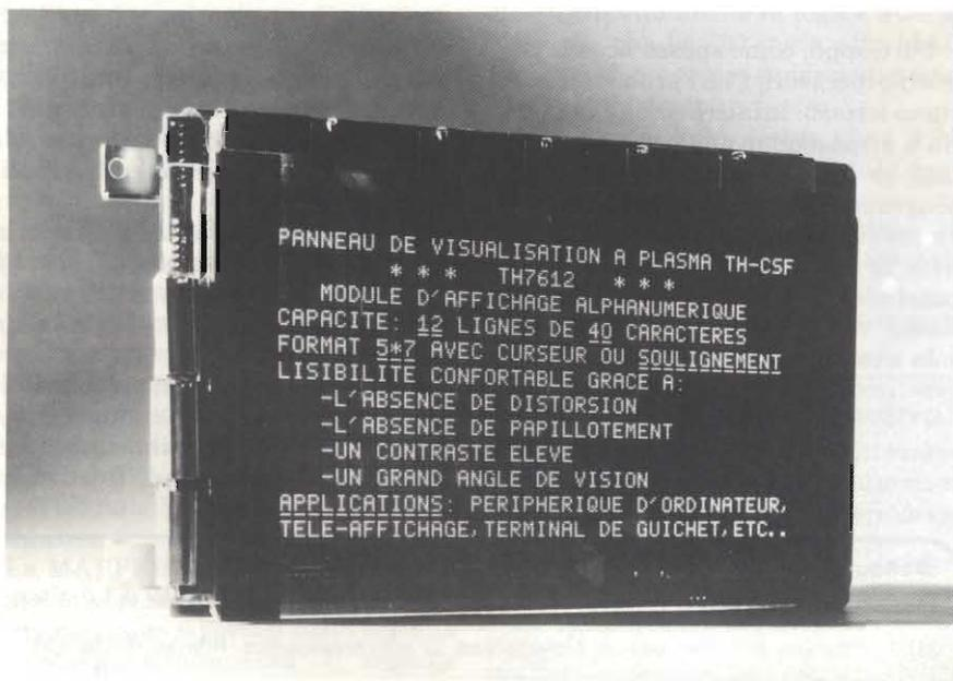
Pannello al plasma a basso profilo dotato di elettronica di controllo incorporata, e che grazie alle sue dimensioni compatte è particolarmente adatto per l'impiego in terminali di computer.
